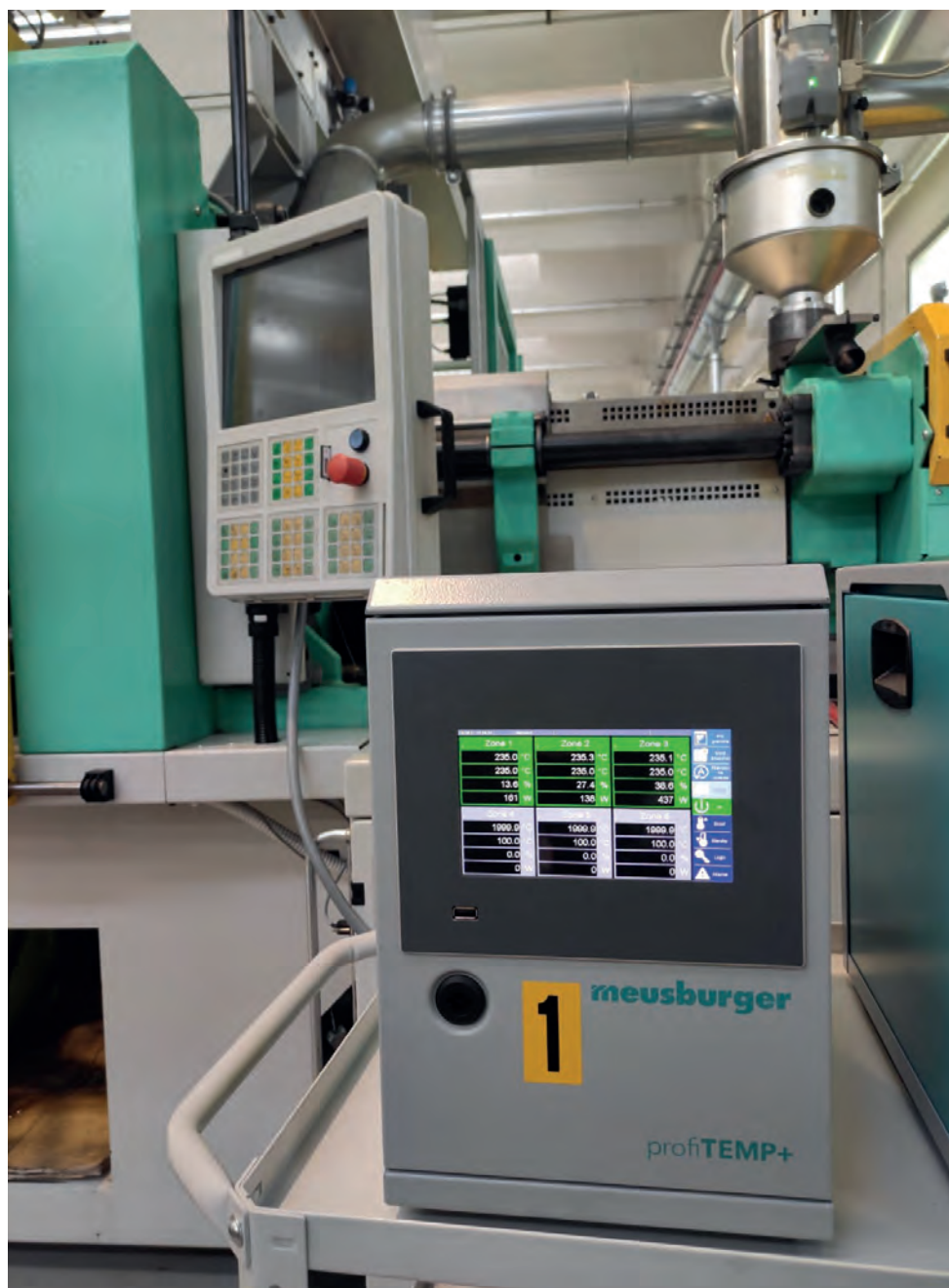
Centralina profiTEMP+ collegata a una pressa ad iniezione.
